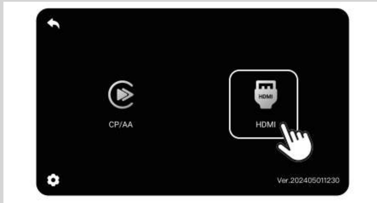
2.HDMI入力ソースを挿入すると、車両の画面が自動的にHDMI画面を再生します。
